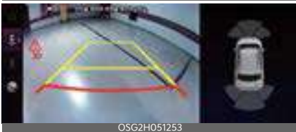
A: Collision warning
