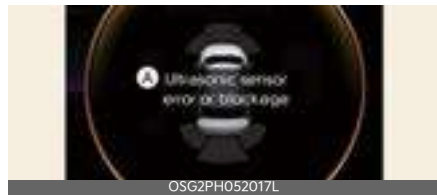
A: Ultrasonic sensor error or blockage
