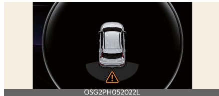
A: Ultrasonic sensor error or blockage
