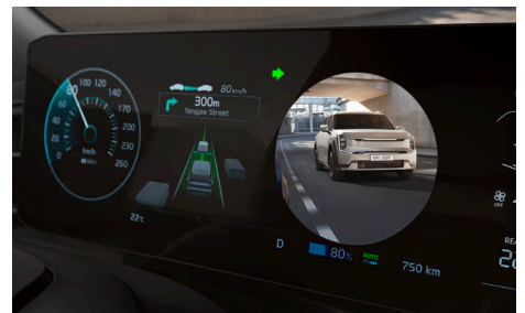
ระบบแสดงภาพมุมมองอับสายตาตามหน้าจอบริเวณกระจกมองข้าง (Blind-Spot View Monitor (BVM))
