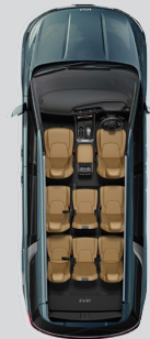
เบาะแถวที่ 4 แบบ Pop-up Sinking พับเก็บได้ราบเรียบ
